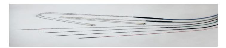
Un circuit de réglage peut seulement régler, quand le régulateur connait la température actuelle et peut la comparer avec la valeur prescrites. Pour cela une sonde est nécessaire. Les thermocouples ou sondes sont fabriqués en différentes versions et types. Nous différencions entre thermocouples/sondes et sondes à résistance (Pt 100). Selon application une sonde adéquate doit être choisie. Imminent que le régulateur reconnait la sonde connectée.
